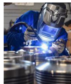
Certains moules font l'objet de rechargement de matière, un véritable travail d'orfèvre (Photo STÉPHANIE PÉRON)
